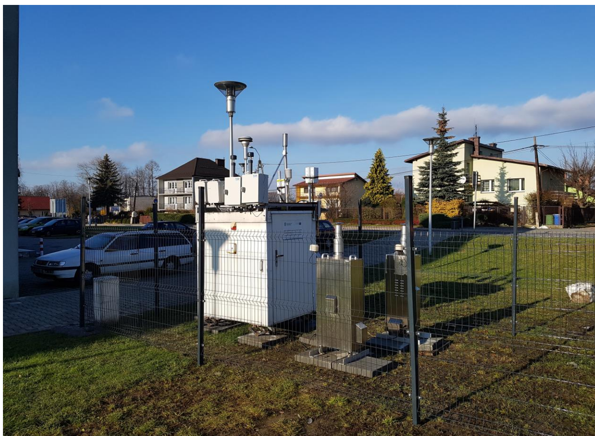
Fot.1. Poborniki pyłowe i stacja pomiarowa zainstalowane w punkcie pomiarowym
